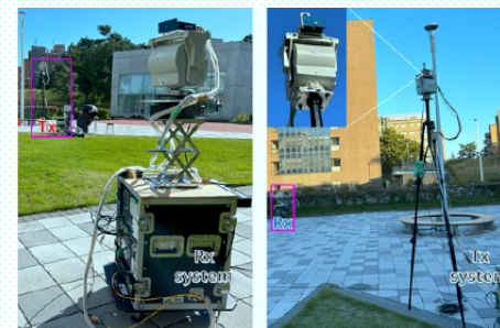
154・300 GHz THz伝搬測定装置 情報通信研究機構(NICT)プロジェクト
